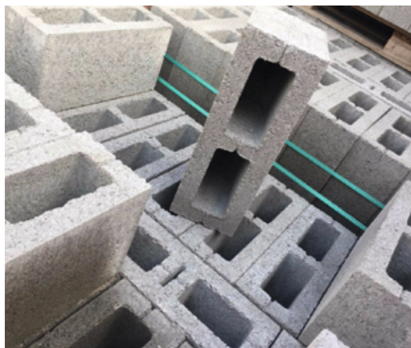
Leichtbeton-Hohlblöcke für die Verwendung im Mauerwerksbau
